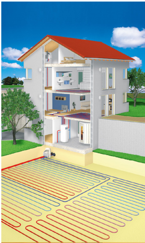
Figur 3.4. Tegning af system med jordvarmepumpe [Comfort, 2009].
